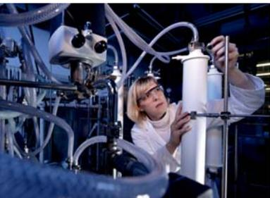
Chromatographie ou encore l'adsorption membranaire sont disponibles au sein de l'ITCI et peuvent être appliqués à des processus industriels allant du laboratoire à l'échelle de production.
